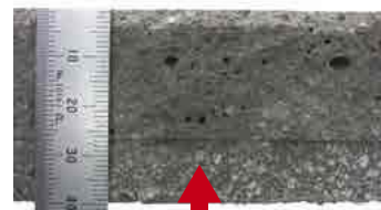
ZモルタルS-HB工法 4mm程度の深さまで含浸
