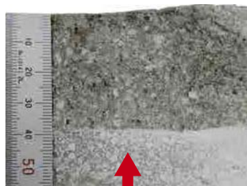
ZモルタルS-HB工法 透過なし
