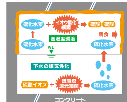
下水処理施設に特有な硫酸腐食の概念図
