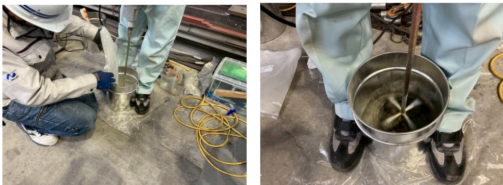
写真 4-7 粉体の投入と練り混ぜ
