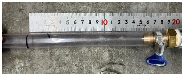
写真 4-9 作業前滴下試験用ホース 長さ 150 mm
