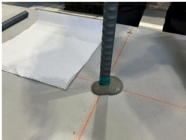
写真 4-16 アンカー筋の挿入
