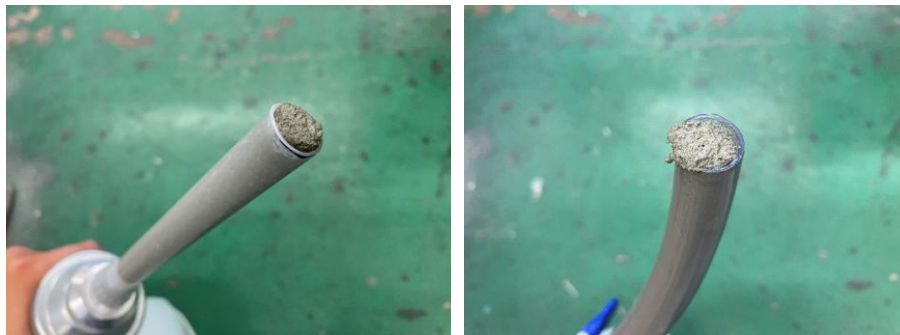
写真 4-10 先端材料の摺り切り例 (左:ノズル、右:ホース)
