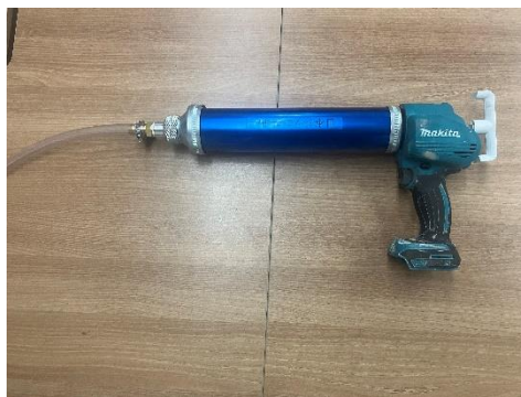
写真 2-3 ロックフィルボンド専用電動ガン
