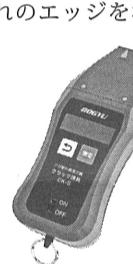
け、測定ボタンを押すだけで作業が完了するため、作業者ごとの測定値のバラつきを最小限に抑えられる。測定履歴は最大10件までさかのぼることが可能。デジタル表示で数値が見やすく、小型で軽量のため、狭い場所や暗い場所でも測定しやすい。
