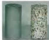
左:Zモルタル 右:コンクリート 5%硫酸浸漬状況 耐硫酸モルタル防食工法
